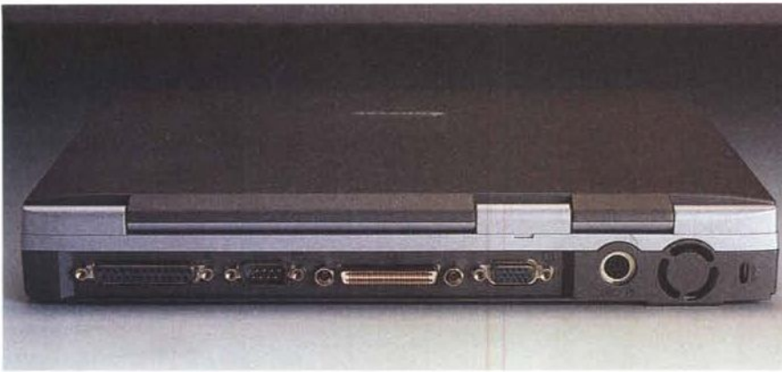
Sul retro, oltre alle comuni porte, è visibile un connettore proprietario per collegare esternamente il modulo floppy o quello CD-ROM.
